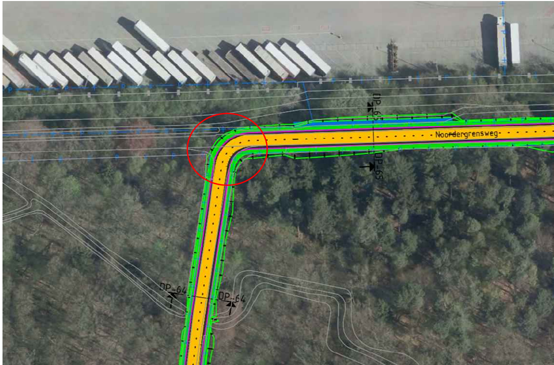
Figuur 11. Ontwerp F35 (fietsstraat) over de Noordergrensweg en Bergweg. De boogstraal van de overgang Noordergrensweg-Bergweg is krappert dan 20 meter.
