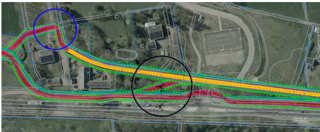
Figuur 15. De twee varianten langs het Prins Bernhardpark. In geel de fietsstraat over de parallelweg en in rood de opwaardering van de bestaande fietsinfrastructuur langs de westzijde. Aan de linkerzijde de aansluiting op bouwsteen 2 richting Meijerinksweg. De blauwe cirkel geeft de haakse bocht weer. De subvariant bevindt zich ten zuiden van de aansluiting op de N733 (rode verbinding tussen fietsstraat en fietspad westzijde (zwarte cirkel)).
