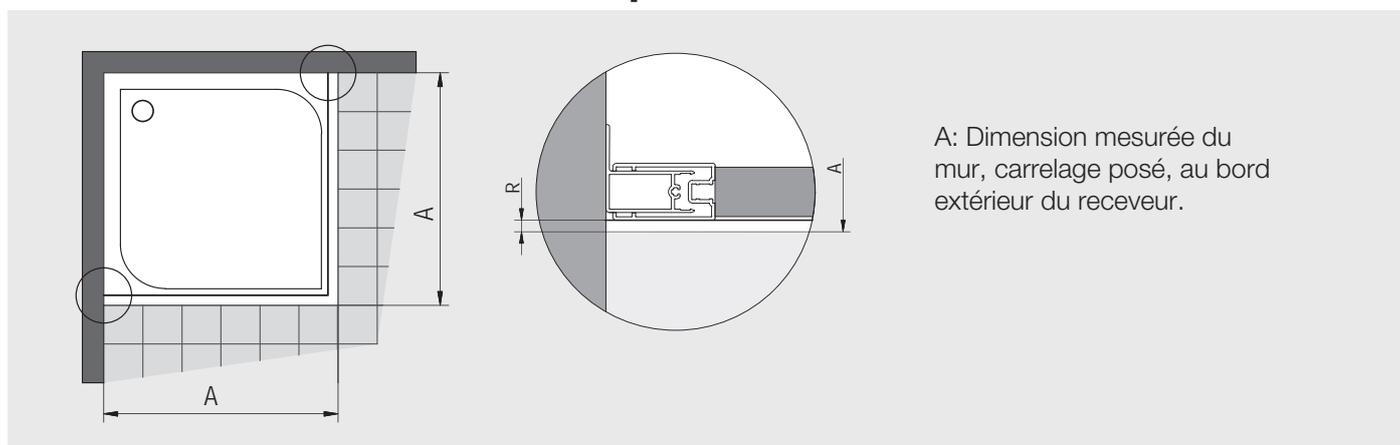
**Schéma 1:** Le retrait R pour une pose sur receveur est à adapter aux caractéristiques du receveur pour des parois standards ou sur-mesure.
