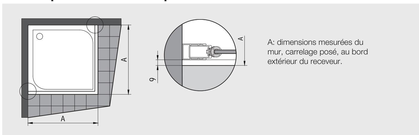
A: dimensions mesurées du mur, carrelage posé, au bord extérieur du receveur.
