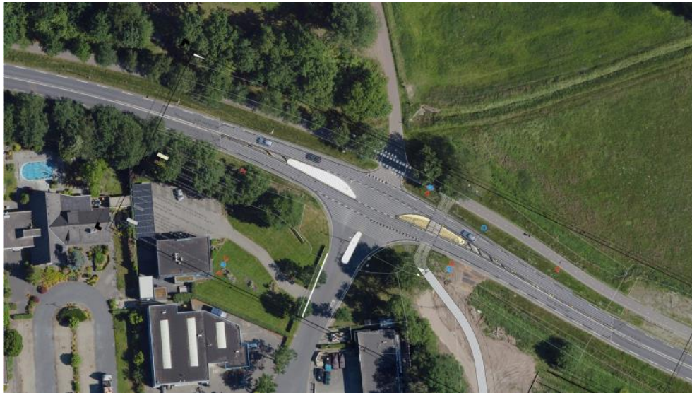
Figuur 2: de werktekening van de aangepaste oversteek geprojecteerd op luchtfoto
